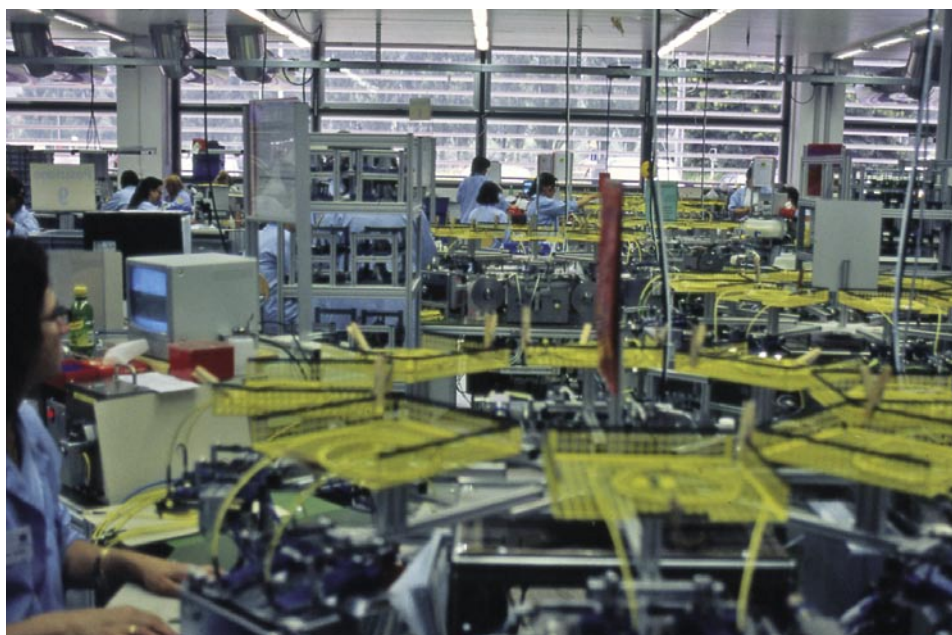
Schleif- und Poliercenter («Spinne»): Hier werden die Steckeroberflächen für eine dämpfungsfreie Übertragung mit sehr feinem Schleifpapier und Diamantflüssigkeit poliert.
